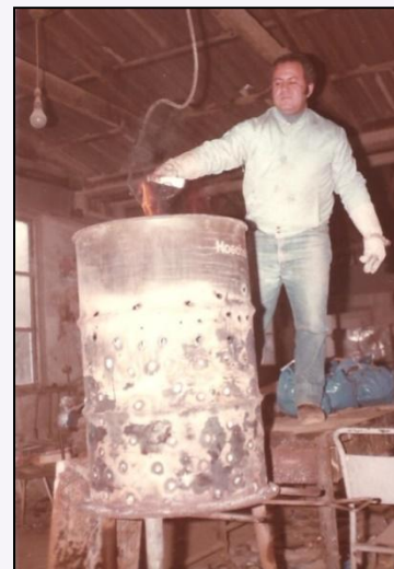
Κατασκευή ενεργού άνθρακα
