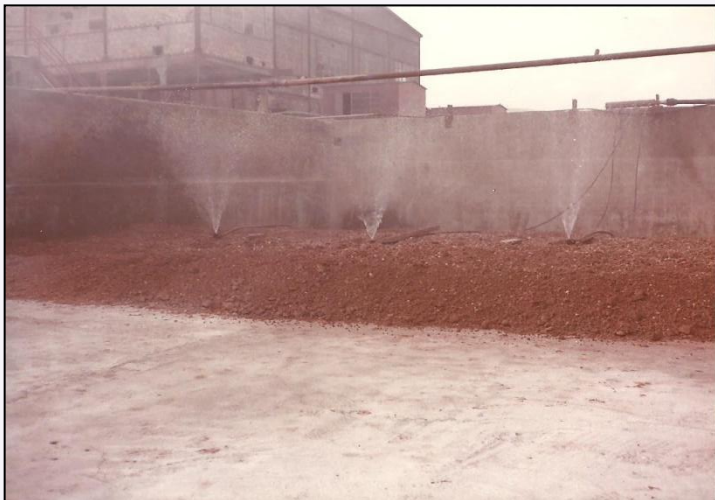
Ημβιομηχανικής κλίμακας δοκιμή εκχύλισης σωρών
