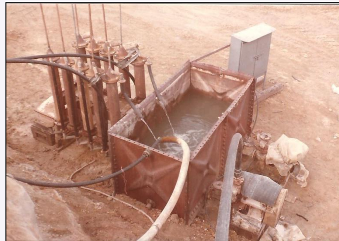
Πιλοτική διάταξη στηλών ενεργού άνθρακα
