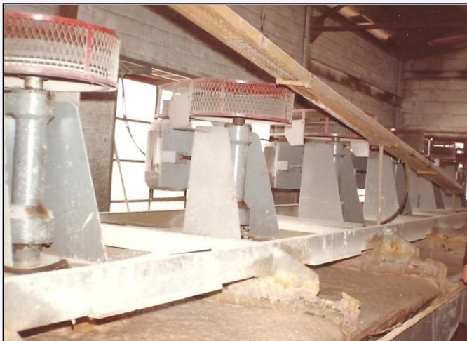
Παραγωγή χρυσοφόρου συμπυκνώματος πυρροτίτη με τη μέθοδο της επίπλευσης
