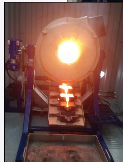
Ανατρεπόμενη κάμινος χωνευτηρίου κατά τη χύτευση
