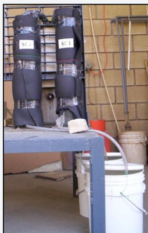
Πιλοτικές δοκιμές εκχύλισης εν θερμώ: Στήλες εκχύλισης 1m και 2m
