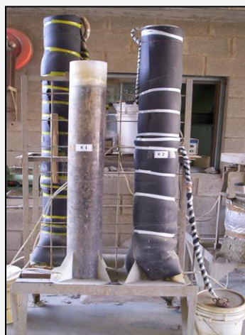
Πιλοτικές δοκιμές εκχύλισης εν θερμώ: Στήλες εκχύλισης 1m και 2m
